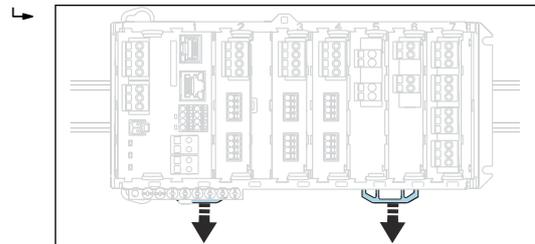
2. Das Gerät von oben in die Hutschiene hängen (a) und es anschließend nach unten (b) festdrücken.
