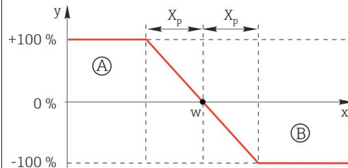
97 Rot: Überlagerung der Kurven der beiden 1-seitigen Regler.
