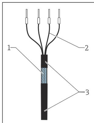
34 Konfektioniertes Kabel
