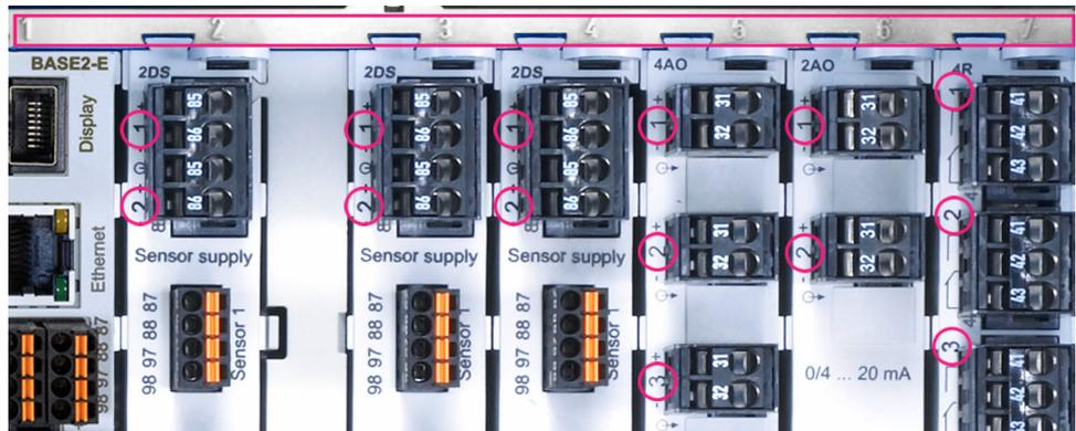
5 Slot- und Portkodierung der Hardwaremodule
