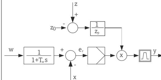
Streng genommen handelt es sich bei einer Störgrößenaufschaltung um eine Steuerung, da deren Auswirkung nicht unmittelbar gemessen wird. Das bedeutet, der Wirkungsfluss ist ausschließlich nach vorne gerichtet. Daher auch die englische Bezeichnung "Feedforward Control".
