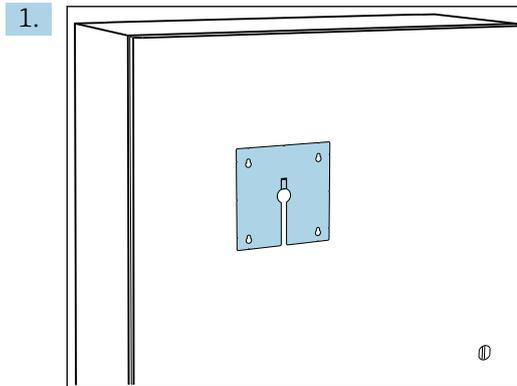
Montageplatte von außen an die Schaltschranktür halten. Dafür die Position wählen, an der das Display montiert werden soll.
