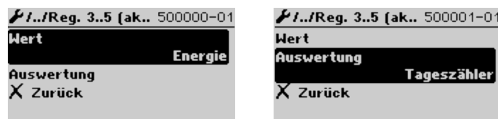
4 Modbus Setup, Parameter zuweisen
